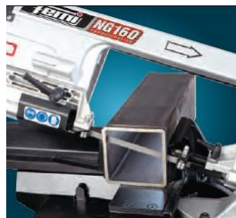
Beweglicher Bandführungsarm, einstellbar auf Materialbreite
