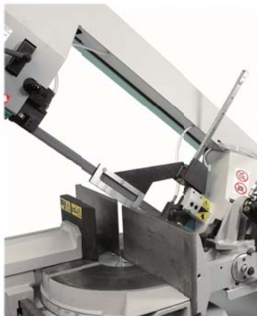
Materialdetektor für optimale Zykluszeit (nur SHI-Modelle)
