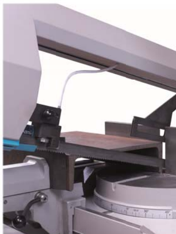
Materialdetektor für optimale Zykluszeit (nur SHI-Modelle)
