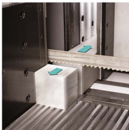
X-TECH 410 & X-TECH 630: Material wird automatisch vom Sägeband wegtransportiert, um die Zahnspitzen des Sägebandes nicht zu beschädigen.
