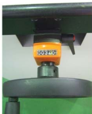
GAA 350-90-TR - GAA-600-90-TR: Längeneinstellung mittels Handrad und Ziffernrollenanzeige
