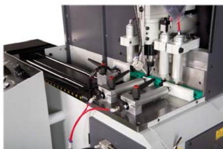
GAA 350-90-CNC-TR12: Detailansicht Materialvorschub, Spann- und Bohreinheit
