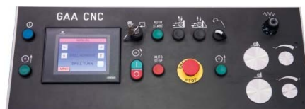
GAA 350-90-CNC-TR - GAA-600-90-CNC-TR: Bedienpanel mit Touchscreen
