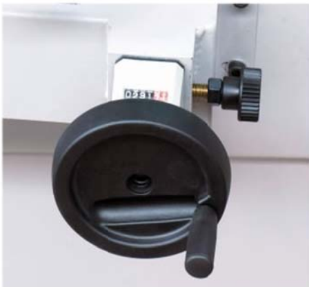
Serie AFI-E: Längeneinstellung mittels Handrad und Ziffernrollenanzeige
