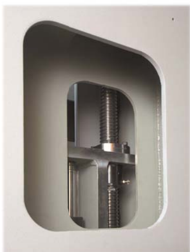
Bewegung aller lineargeführten Teile über Kugelgewindespindel
