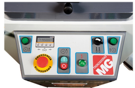
Bedienpanel mit Option „Digitale Winkelanzeige“
