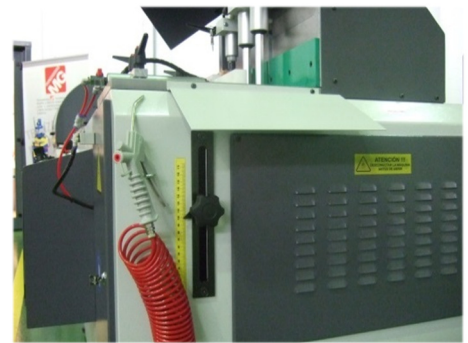
GAA 350-90-TR - GAA-500-90-CNC-TR: Schnitthöhenbegrenzung manuell mit Stellschraube auf Nonius & Druckluftpistole
