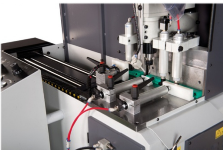
GAA 350-90-CNC-TR12: Detailansicht Materialvorschub, Spann- und Bohreinheit
