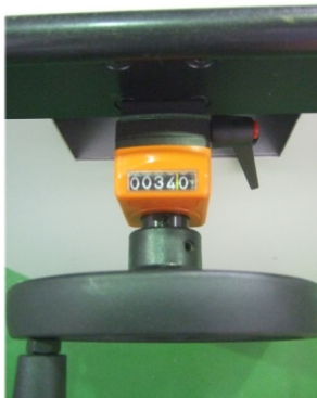
GAA 350-90-TR - GAA-600-90-TR: Längeneinstellung mittels Handrad und Ziffernrollenanzeige
